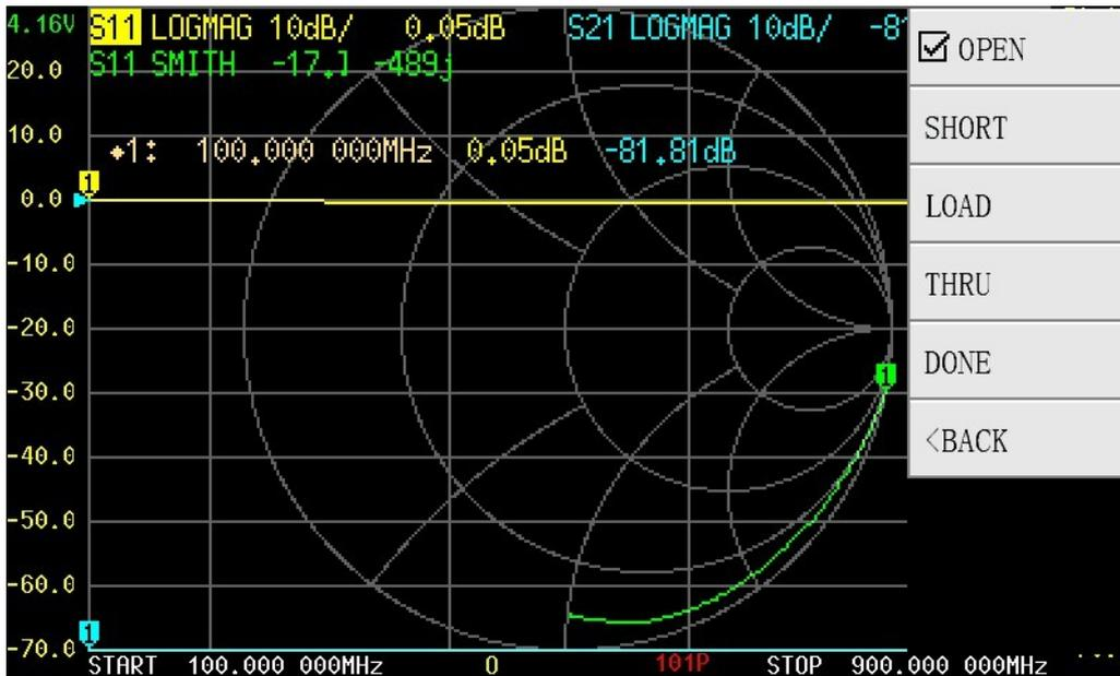
**REMARQUE** : il est généralement nécessaire de connecter l'objet sous essai au VNA à l'aide de câbles ; à ce moment-là, le câble devient une partie du système de mesure et l'extrémité du câble doit être considérée comme le port du VNA lors de l'étalonnage.
