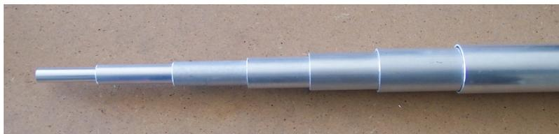
Placez le semi-dipôle sur une surface, et commencez à faire glisser le plus petit diamètre, il a plusieurs trous qui vous permettent de varier la résonance de base de l'antenne, car la résonance peut être influencée par le milieu environnant et aussi varier de manière significative par rapport à la résonance du projet). Le trou 1 est le plus proche de l'extrémité du tube.
