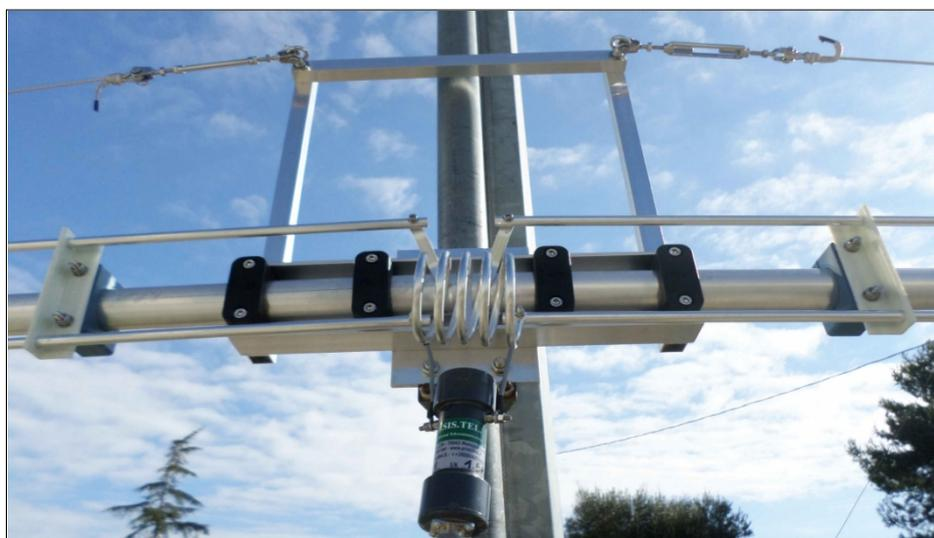
Connecter avec des fils aussi courts que possible, un balun 1-1 (optionnel) ou une self réalisée dans un câble coaxial ou directement aux extrémités de la bobine.
