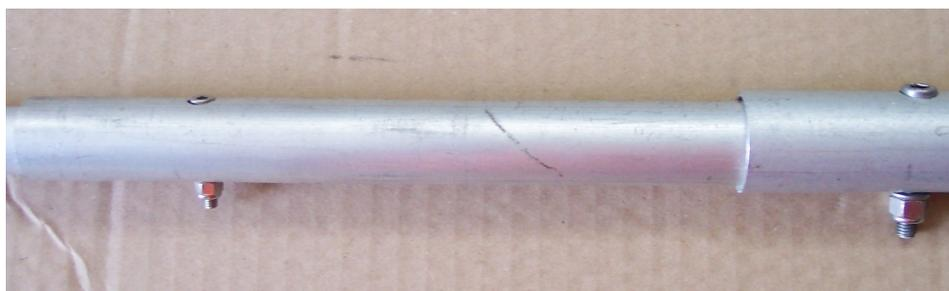
Serrez complètement l'écrou. Veillez à ce que toutes les têtes de goupilles soient du même côté. Avec la même technique, extraire et assembler toutes les sections. Le joint 25-20 mm doit être réalisé à l'aide du boulon à œil (fig. 3).
