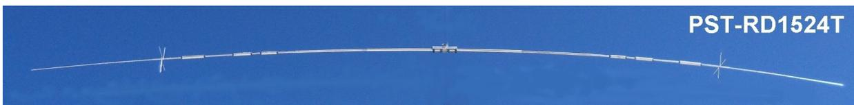
Installez l'antenne sur votre mât, assurez-vous d'avoir près de 5-6 mètres ou 15-20 pieds au-dessus du toit ou du sol et si elle est installée au-dessus d'une antenne HF yagi, assurez-vous d'avoir le dipôle en ligne avec le boom de la yagi en les espaçant de près de 2m ou 8 pieds. L'antenne aura la meilleure performance si elle est installée presque à  $\frac{1}{4}$  d'onde de la bande de fréquence inférieure, au-dessus du sol.
