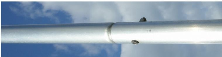
Serrez l'écrou. Veillez à ce que toutes les têtes de boulons soient du même côté.
