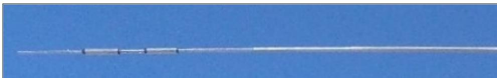
Toutes les sections du tube et l'embout ont de multiples trous qui servent à faire de petites touches d'accord sur les différentes bandes. Certaines parties sont pré-assemblées et pré-étalonnées, si nécessaire, retirez le boulon et déplacez le point d'accord. Calibrez l'antenne en commençant par la bande la plus haute et en allant vers les bandes les plus basses. Les éléments plus longs abaissent la fréquence, les éléments plus courts augmentent la fréquence.
