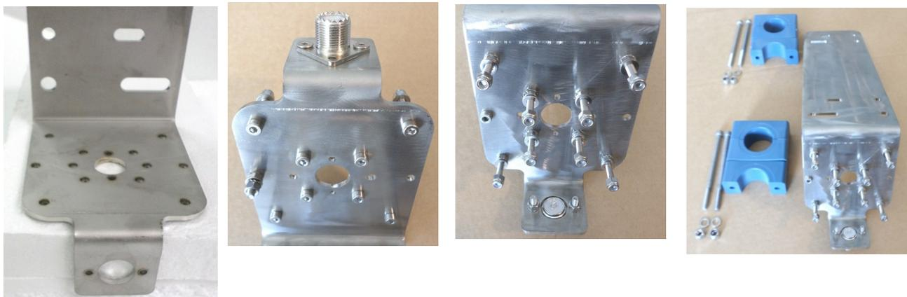
Installer les 8 boulons 4x25MA dans les trous en forme de X et le boulon 4x16 dans le trou latéral comme indiqué sur les photos. Séquence d'assemblage correcte pour tous les boulons : boulon, rondelle dentelée, écrou normal, deux rondelles plates et écrou autobloquant. **Bloquer soigneusement tous les boulons de serrage de l'écrou normal.**
