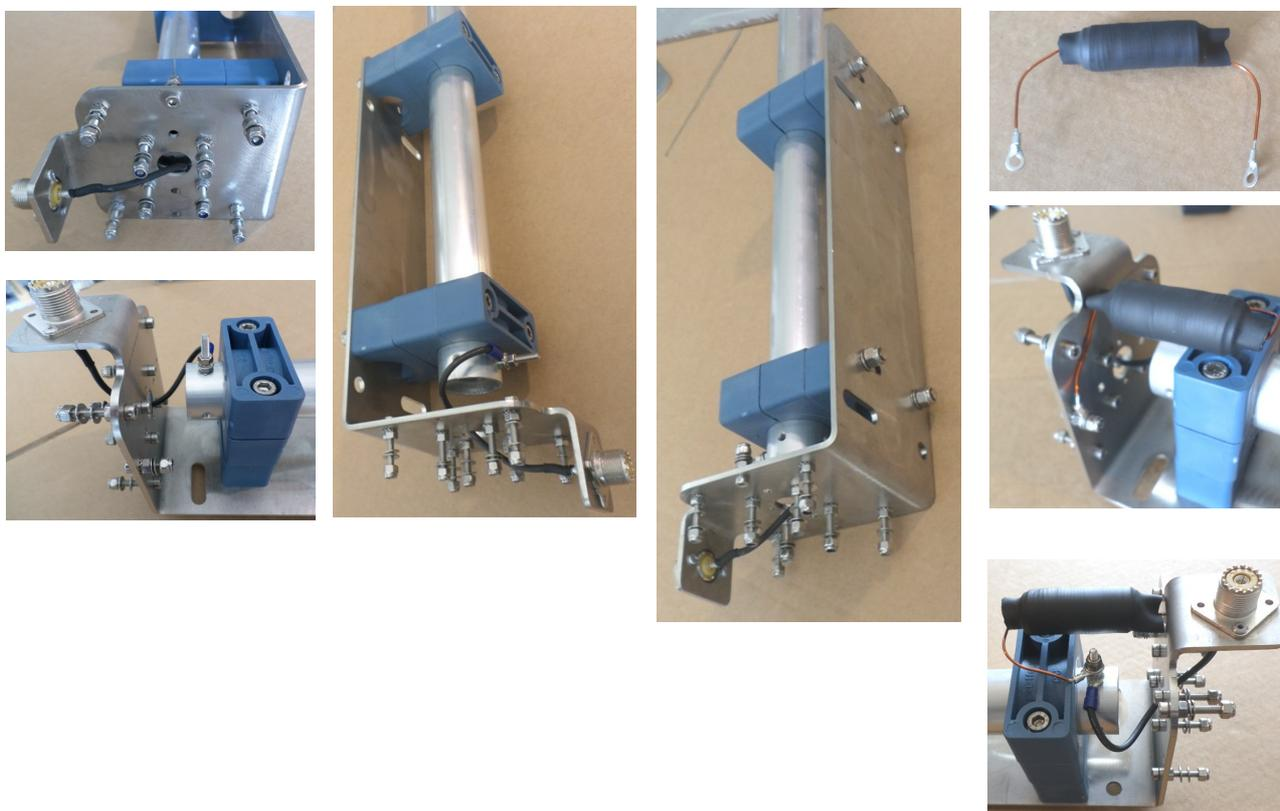
Le soin et la précision de cet assemblage assureront une longue durée de vie à l'antenne. Vérifier que tous les boulons ont été correctement fixés et compléter l'assemblage du radiateur.
