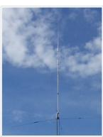
L'antenne avec des radians pleins peut être installée à n'importe quelle hauteur. La version avec radians en fil métallique sera plus performante si elle est installée à 10-20 cm au-dessus du sol, avec les radians sur le sol ou sur le toit.
