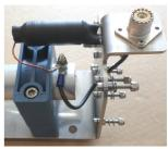
Le soin et la précision de cet assemblage assureront une longue durée de vie à l'antenne. Vérifier que tous les boulons ont été correctement fixés et compléter l'assemblage du radiateur. A l'aide des boulons en U, installez la base sur le poteau de support et installez les radiaux solides. Le boulon en U a une largeur de 50 mm, il peut recevoir des poteaux ou des tubes de 40 à 50 mm.
