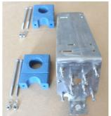
Installer les 8 boulons 4x25MA dans les trous en forme de X et le boulon 4x16 dans le trou latéral comme indiqué sur les photos. Séquence d'assemblage correcte pour tous les boulons : boulon, rondelle dentelée, écrou normal, deux rondelles plates et écrou autobloquant. Bloquer soigneusement tous les boulons de serrage de l'écrou normal.
