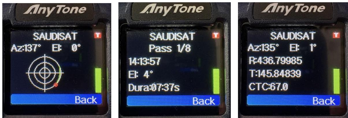
En utilisant le **bouton Zone** au centre, vous pouvez passer d'une image à l'autre parmi les trois images ci-dessus. Le **bouton de canal** situé sur le dessus de la radio contrôle le squelch, vous pouvez donc désactiver la fonction squelch et entendre le satellite et le bruit qu'il génère (il est presque indispensable de désactiver le squelch pour écouter un satellite). Vous pouvez entendre des voix d'amateurs lorsque le satellite est
