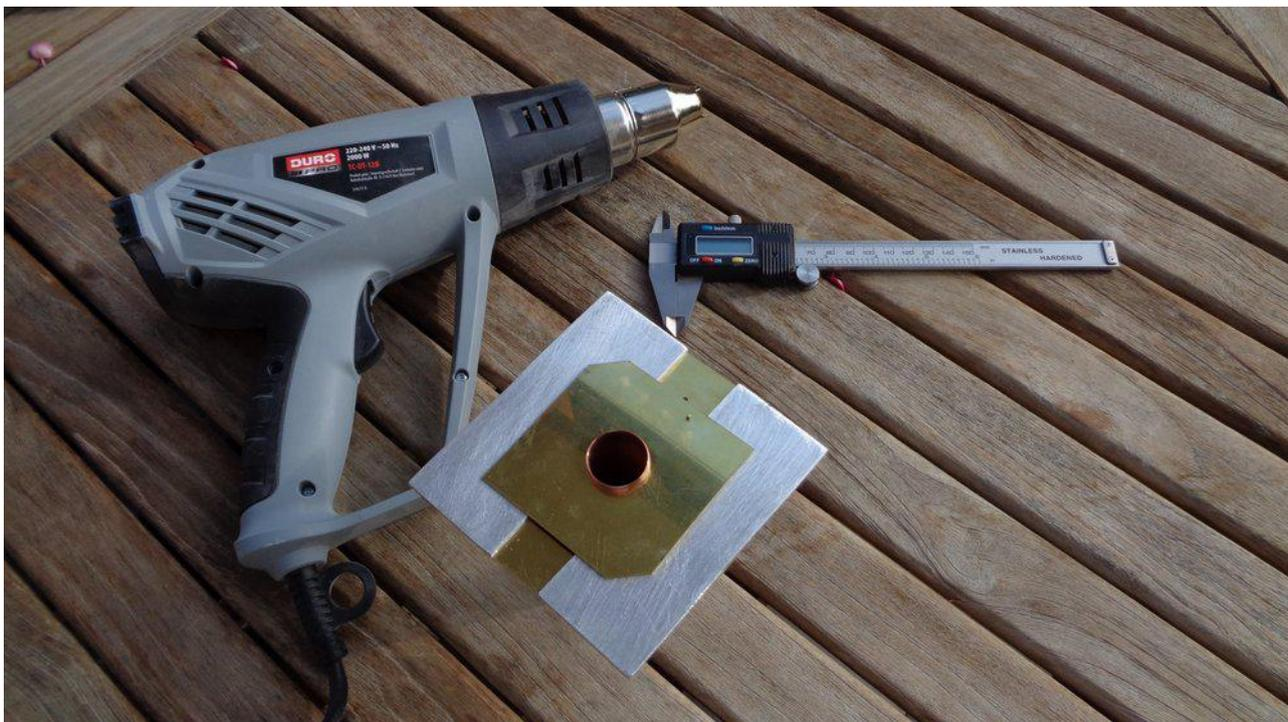
Soudez le picot de la SMA (ne pas trop chauffer pour ne pas faire fondre le diélectrique de la SMA).
