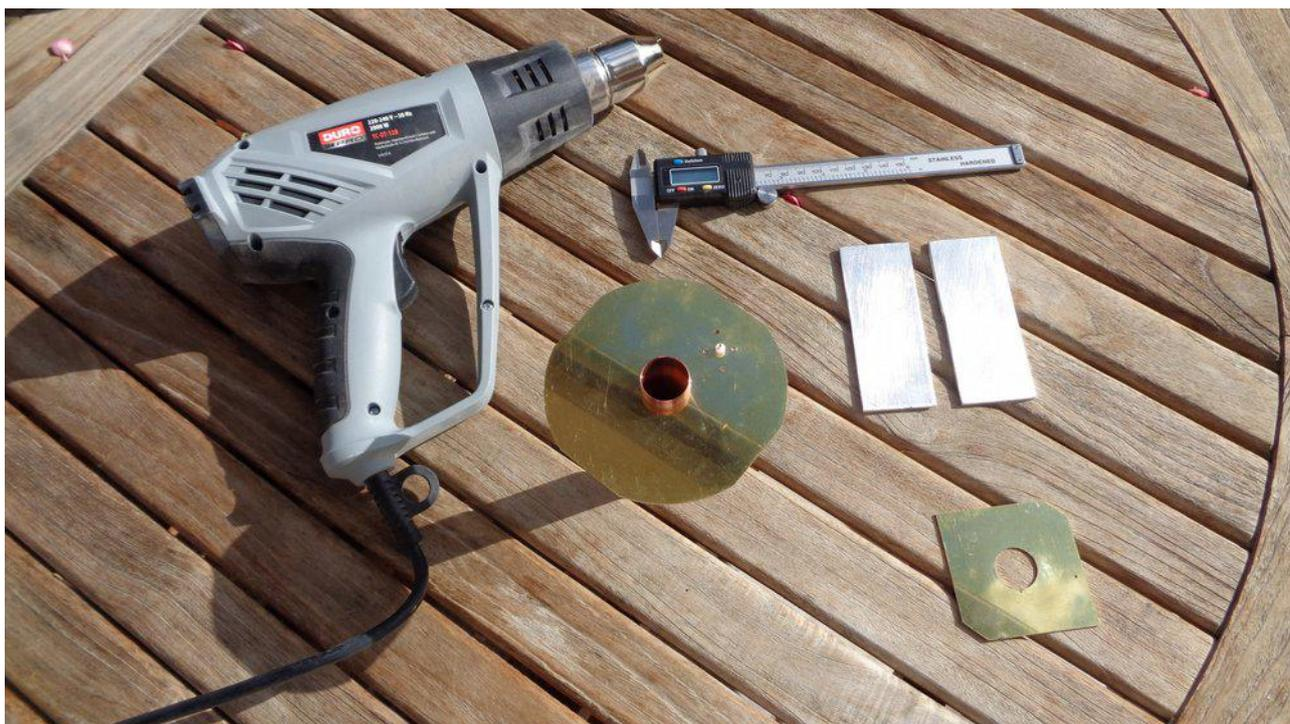
Positionnez le réflecteur et le patch sur le tube de 22mm à blanc avant de souder.
