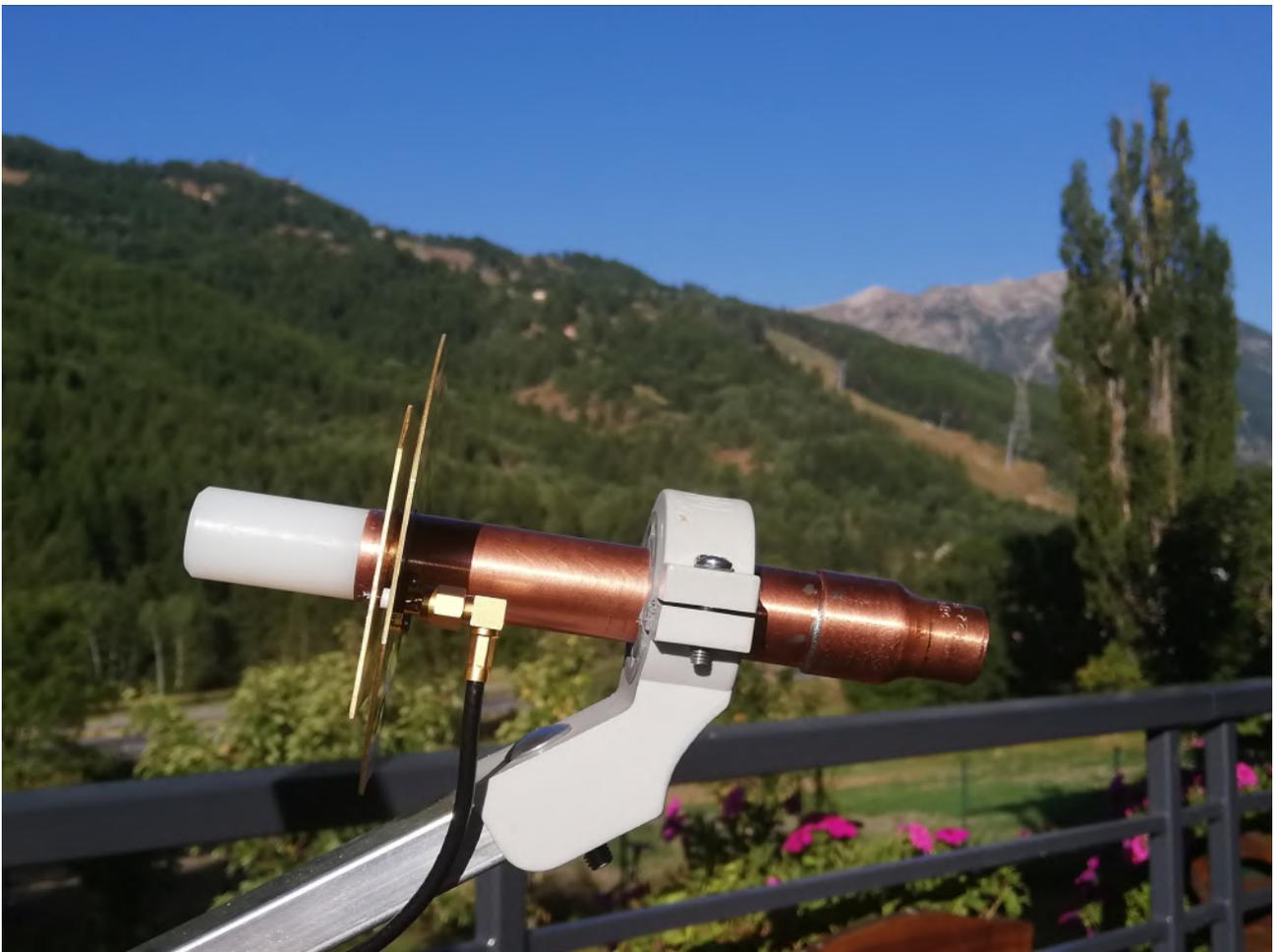
Manuel de montage de l'antenne POTY pour le satellite Oscar 100 (QO-100).
