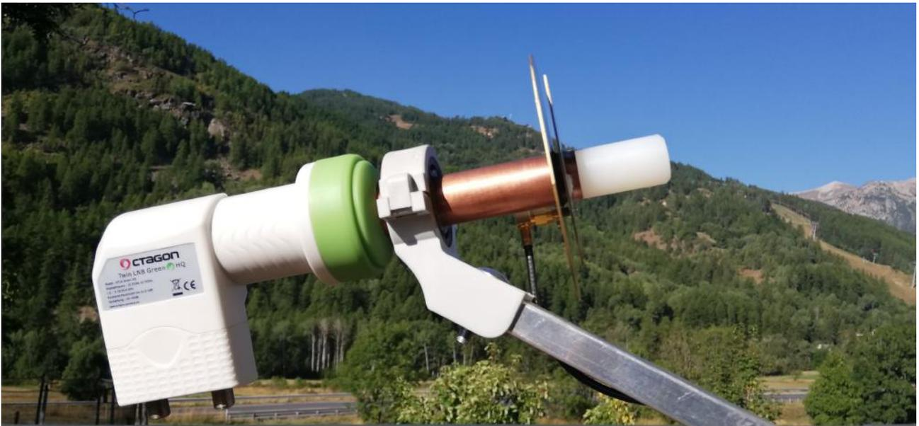
Faites une étanchéité sur le tube et le capuchon plastique
