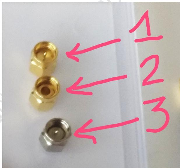
L'étalonnage de l'isolement du canal 1 nécessite deux charges pour connecter les canaux 0 et 1, respectivement, pour obtenir la meilleure isolation, généralement avec un seul jeu de bouchons d'étalonnage, on met le bouchon de charge fictive (50 ohms) sur le port 0, et on connecte le bouchon court-circuit à CH 1, rester sur le menu de calibration du CH 0, puis appuyez sur le menu ISOLN pour effectuer le calibrage.
