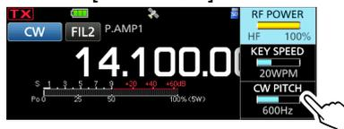
4. Tourner **[MULTI]** pour régler la hauteur CW entre 300 et 900 Hz (par pas de 5 Hz).
